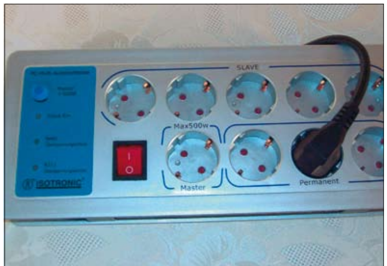
Eine Steckdosenleiste mit Master-Slave-Funktion sowie permanenten Steckern. Die Slave-Steckdosen bekommen nur Strom, wenn das Hauptgerät an ist.
